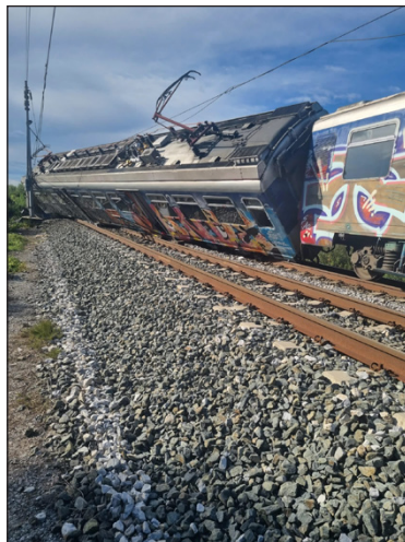
Slika 3. Vagon prislonjen na stup električne mreže
